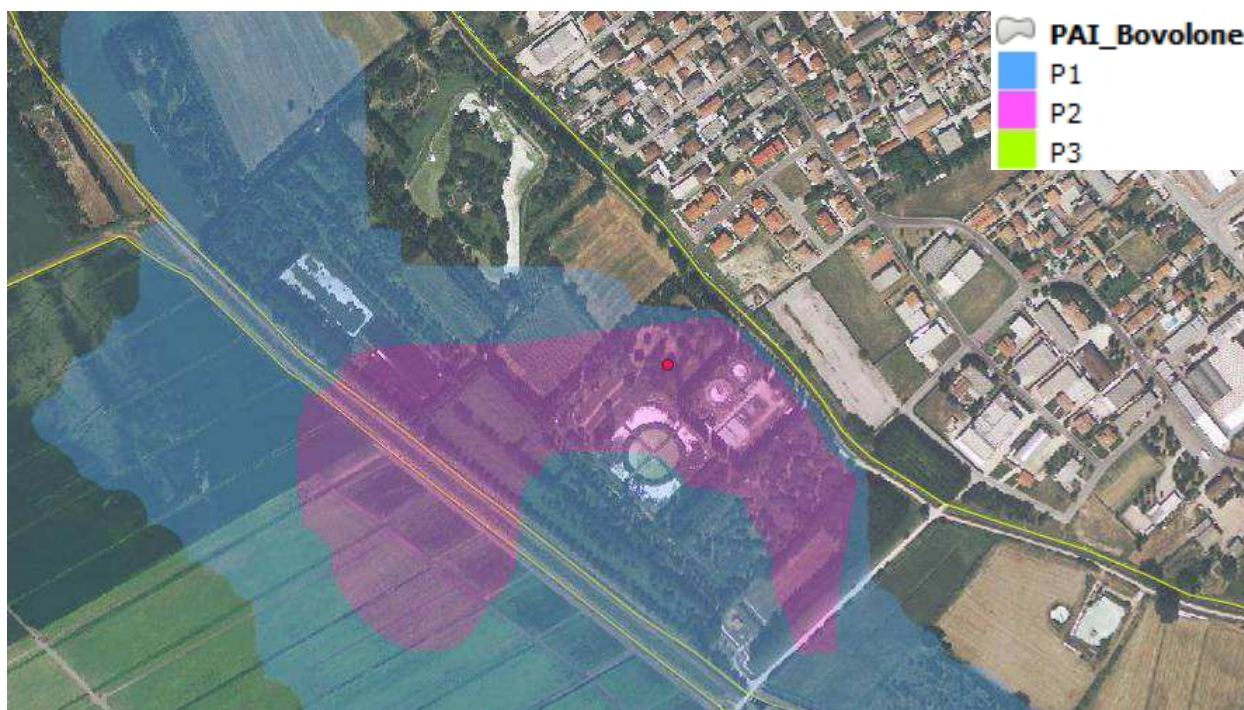
Figura 54 – Localizzazione del depuratore comunale in zona P2 del P.A.I., in giallo la rete dei canali consortili. Consorzio di Bonifica e Q.C. Regione del Veneto
